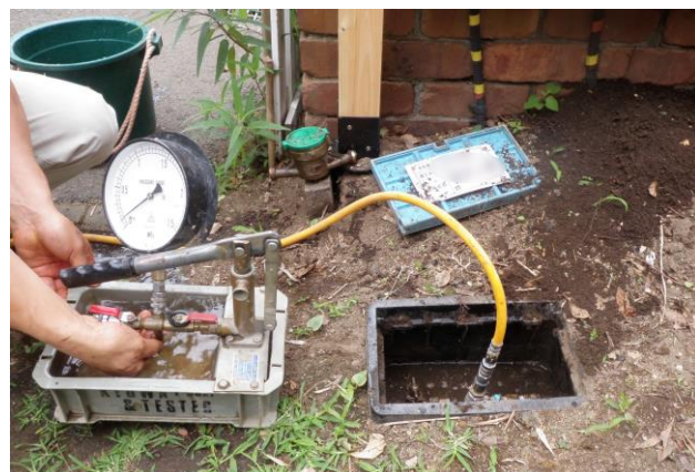
手動ポンプにて 給水管へ加圧中
